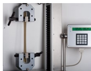
urządzenie do pomiaru wydłużenia pod wpływem działania siły w celu zbadania wytrzymałości mechanicznej mediów filtracyjnych
